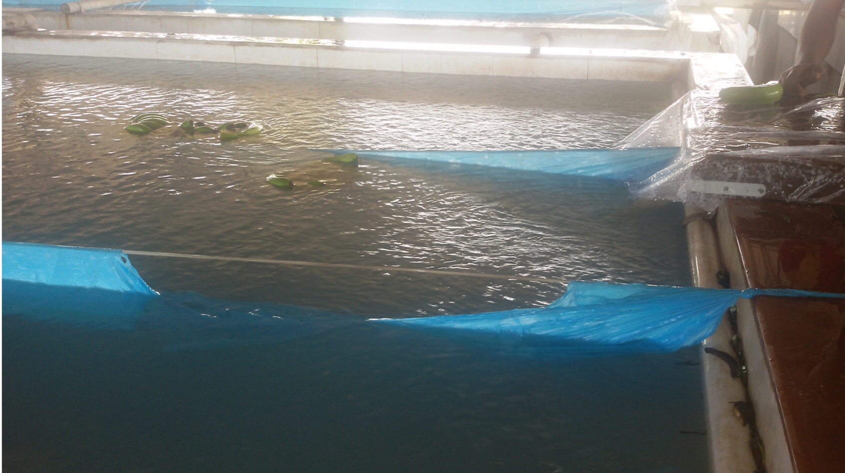
Washing Tank मधील Grading Partition
